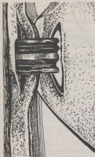
Рис. 24. Соединение кованных изделий хомутом
